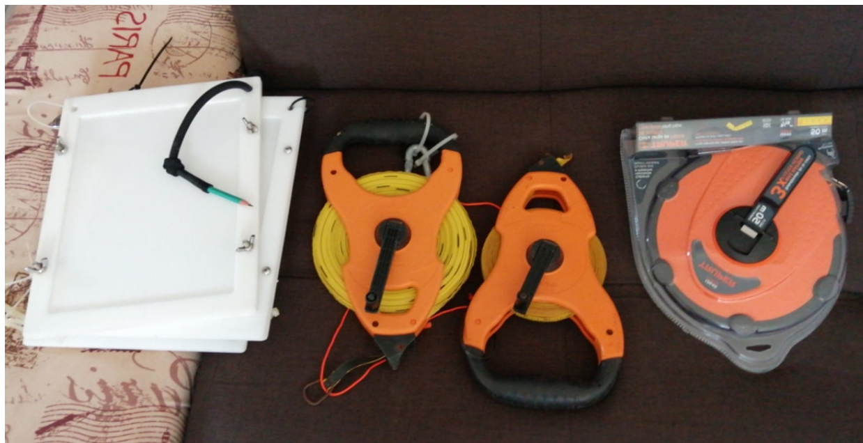
Figura 10. Tablas acrílicas para la toma de datos con papel contra agua y cintas métricas
